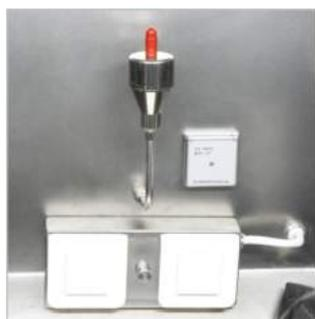
В рабочей зоне находится **ПРОБООТБОРНИК ДЛЯ ПОДКЛЮЧЕНИЯ СЧЕТЧИКА ЧАСТИЦ**, жестко закрепленный на задней стенке рабочей камеры.
