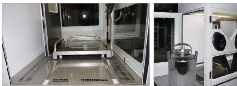
**БОЛЬШАЯ ГЕРМЕТИЧНАЯ РАБОЧАЯ КАМЕРА** позволяет размещать емкости объемом до 50 кг.
