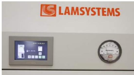
Управление осуществляется с помощью **СЕНСОРНОГО ЭКРАНА** – собственной разработки компании. Сенсорный экран позволяет работать в перчатках и осуществлять влажную обработку дезинфицирующими средствами (в т.ч. перекисью водорода).
