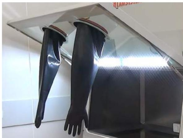
**РАБОЧАЯ КАМЕРА ПРИСПОСОБЛЕНА К ОЧИСТКЕ И ДЕЗИНФЕКЦИИ**: имеет скругленные углы, лампу УФ-облучения и съемный блок розеток с внешним выключателем питания. Специальный режим уборки позволяет осуществлять обработку рабочих поверхностей при включенных вентиляторах.
