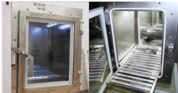
**ГЕРМЕТИЧНЫЙ ПЕРЕДАТОЧНЫЙ ШЛЮЗ** может быть линейным и угловым. Окна в дверях – **ЗАКАЛЕННОЕ СТЕКЛО**.
