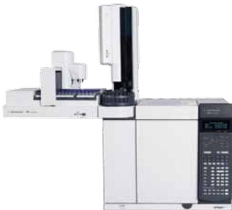
Автосамплер Agilent серии 7693 с каруселью на 16 виал обеспечивает высочайшую скорость и точность ввода жидких проб. Для увеличения производительности автосамплера серии 7693 существует опция установки дополнительного лотка на 150 образцов. Усовершенствованные возможности, такие как автоматическое разведение, добавление внутренних стандартов, нагрев, смешение и добавление растворителя помогают избежать ошибок и искажения результатов.
